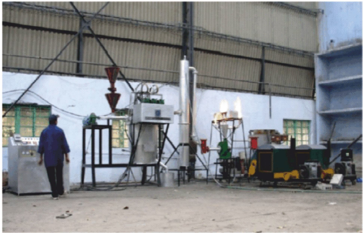
Plasticwaste Plasma Gasifier (20 kg/hr.)
